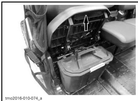
**REMARQUE:** Lorsqu'on réinstalle la boîte de rangement sous le siège, voir à bien l'aligner sur les tubes de siège et les motifs du plancher afin qu'elle soit bien à sa place.
