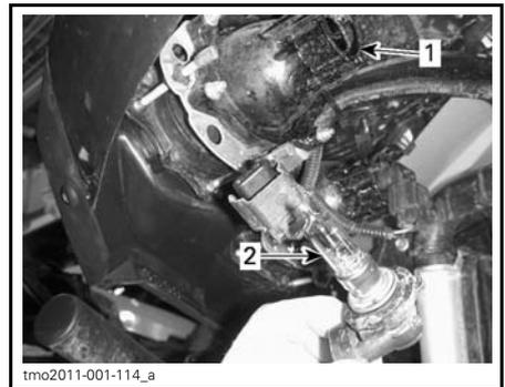
1. Douille de l'ampoule
