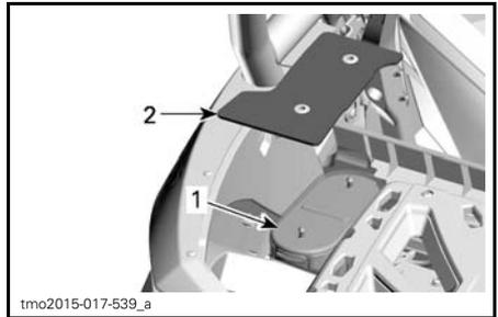
1. Filtre à air arrière de transmission CVC
