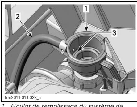
1. Goulot de remplissage du système de refroidissement
