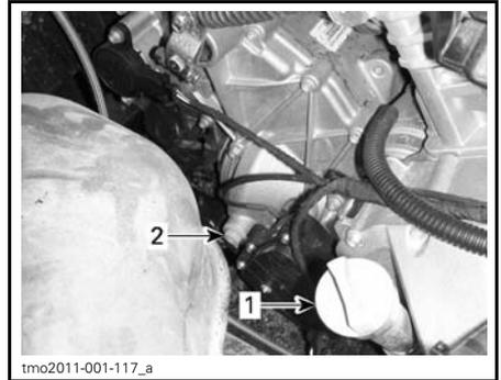
1. Bouchon de niveau d'huile du moteur
