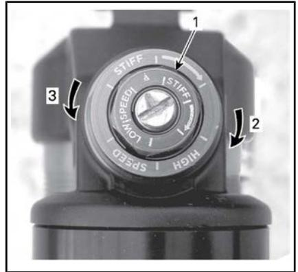
**AMORTECIMENTO POR COMPRESSÃO EM ALTA VELOCIDADE (USE UMA CHAVE INGLESA DE 17 MM)**
