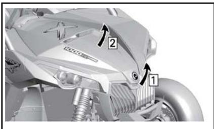
Passo 1: Mantenha levantada a parte frontal da tampa de manutenção
