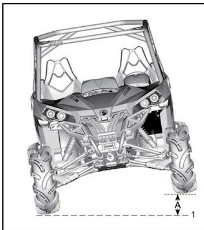
*TÍPICO - ELEVACIÓN DEL LATERAL DEL CONDUCTOR*
