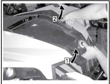
*Eta*pa 1: Mantenga levantada la parte frontal de la tapa de servicio
