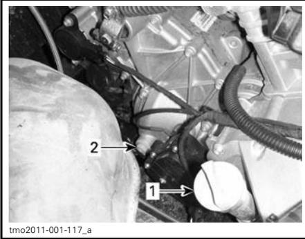
1. Bouchon de niveau d'huile du moteur
