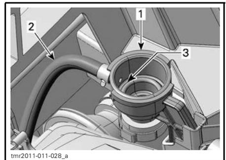
1. Goulot de remplissage de système de refroidissement
