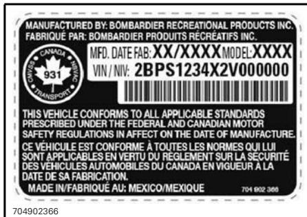
**TIPIQUE — AUTOCOLLANT DE NUMÉRO DE SÉRIE DU VÉHICULE SOUS LA BOÎTE À GANTS**
