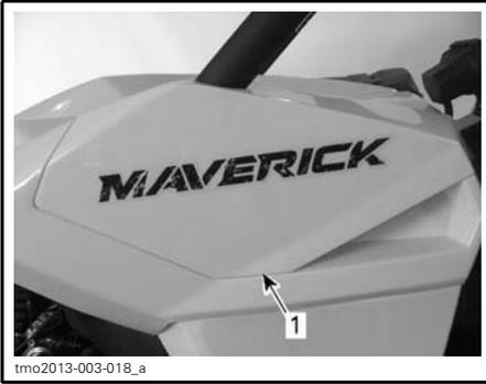
1. Couverture en plastique du filtre à air de la transmission CVC
