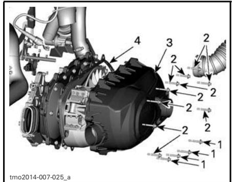
1. Vis inférieures du couvercle de transmission
