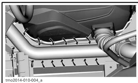
2. À l'aide d'un boyau d'arrosage, nettoyer soigneusement la zone afin qu'il n'y ait plus aucun débris en contact avec l'échappement.
