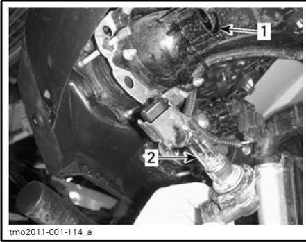
1. Douille de l'ampoule
