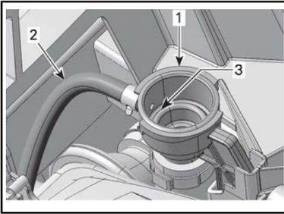
1. Adattatore per il rabbocco del sistema di raffreddamento
