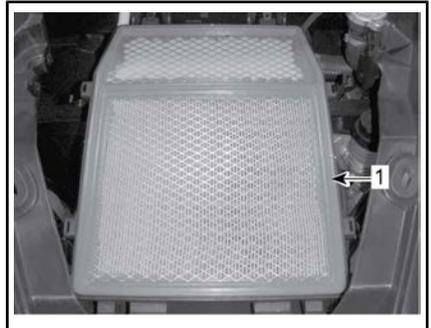
1. Filtro dell'aria del motore
