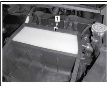
1. Post-filtro dell'aria del motore
