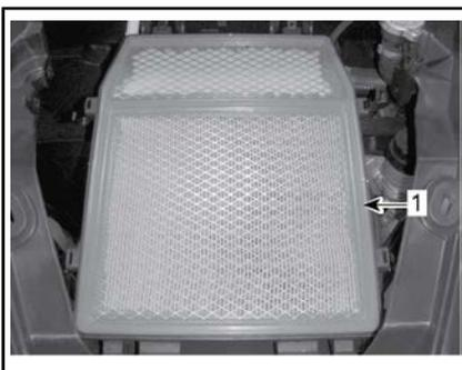
1. Filtro dell'aria del motore
