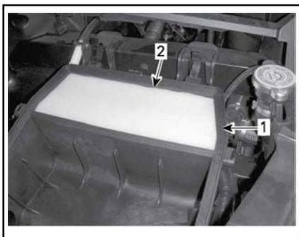
1. Seconda sezione (camera pulita)
