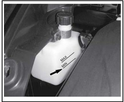
**SERBATOIO DI ESPANSIONE DEL LIQUIDO REFRIGERANTE**
