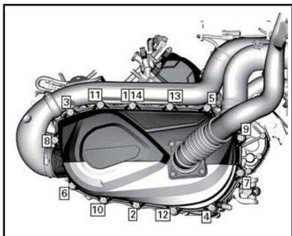
**SEQUENZA DI SERRAGGIO DELLA CARENATURA DELLA CVT**
