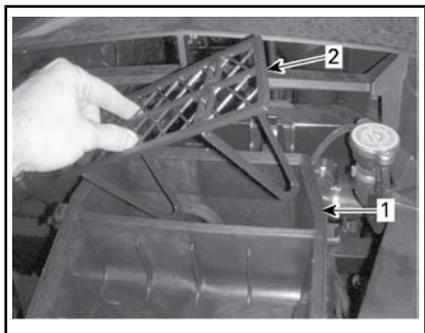
1. Seconda sezione (camera pulita)
