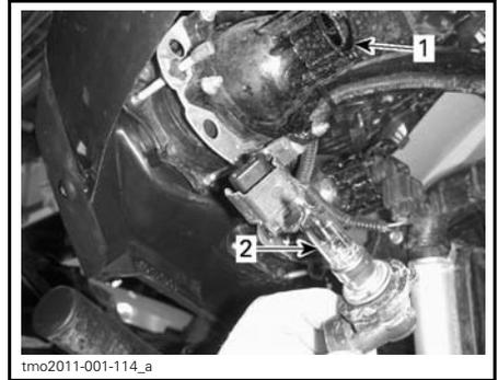
1. Douille de l'ampoule
