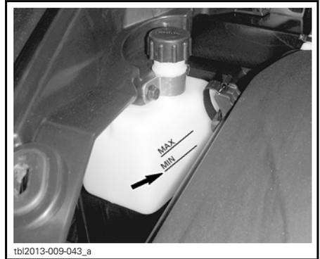
**RÉSERVOIR D'EXPANSION DE LIQUIDE DE REFROIDISSEMENT**
