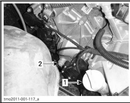
1. Bouchon de niveau d'huile du moteur
