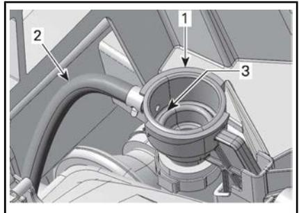
1. *Adattatore per il rabbocco del sistema di raffreddamento*
