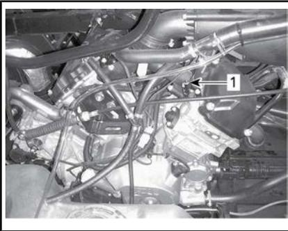
1. Vite di spurgo del cilindro anteriore
