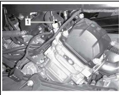
1. Vite di spurgo del cilindro posteriore
