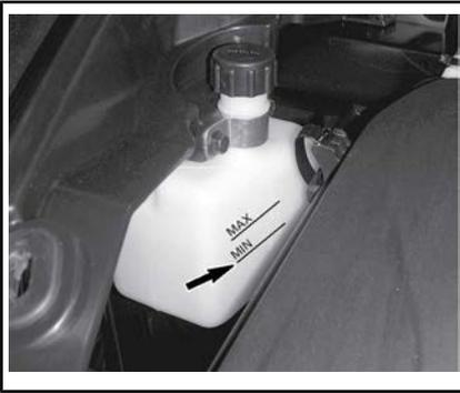
*Configurazione tipica - VASO DI ESPANSIONE DEL LIQUIDO REFRIGERANTE*
