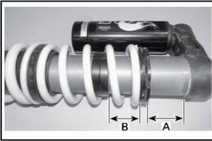
**REGOLAZIONE COLLEGAMENTO - AMMORTIZZATORE POSTERIORE**
