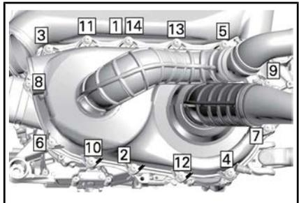
Sequenza di serraggio della carenatura della CVT - MODELLO TURBO
