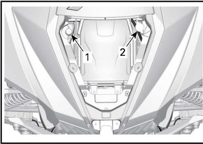
1. Tapón del depósito de expansión del refrigerante
