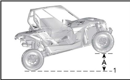
*ELEVACIÓN TOTAL DE LA PARTE DELANTERA DEL VEHÍCULO*
