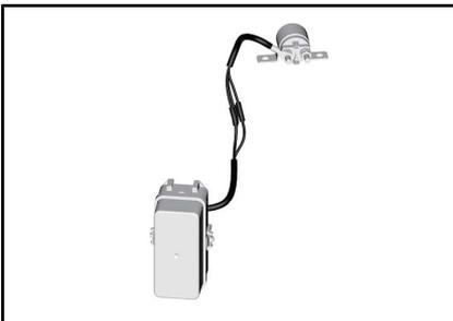
VÁSTAGO FUSIBLE CONECTADO A LA CAJA DE FUSIBLES
