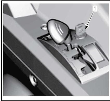
*TÍPICO - LA PALANCA DE CAMBIOS SE PUEDE BLOQUEAR EN LA POSICIÓN DE APARCAMIENTO*
