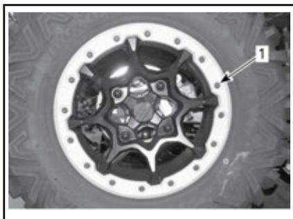
1. Dispositivo di bloccaggio da serrare manualmente
