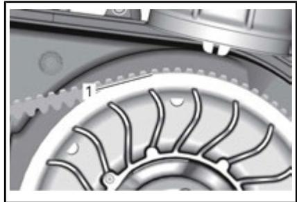
1. Porzione più bassa delle ruote dentate con la superficie esterna della cinghia di trasmissione
