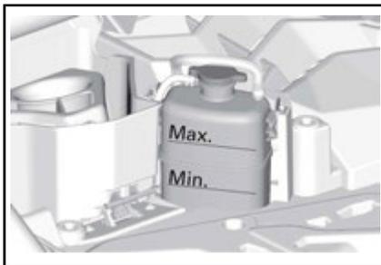
5. Aggiungere liquido refrigerante nel sistema se necessario. Usare un imbuto per impedire
