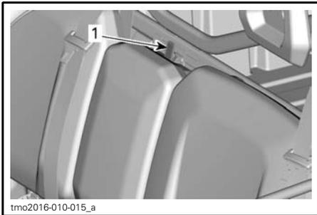
1. Typique - mécanisme de verrouillage du dossier
