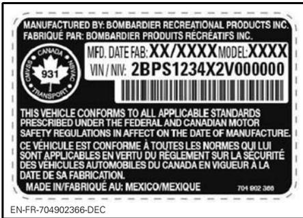
*TYPIQUE ÉTIQUETTE DU NUMÉRO DE SÉRIE DU VÉHICULE SOUS LA BOÎTE À GANTS*
