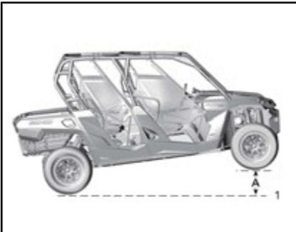
**ELEVACIÓN TOTAL DE LA PARTE DELANTERA DEL VEHICULO**
