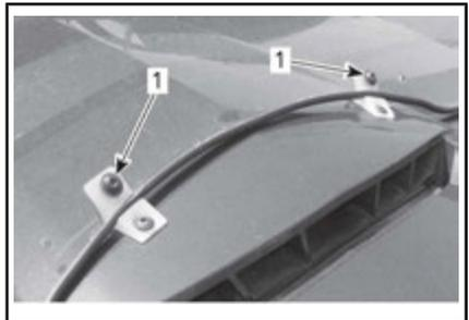
1. Tornillo de sujeción del parabrisas al soporte
