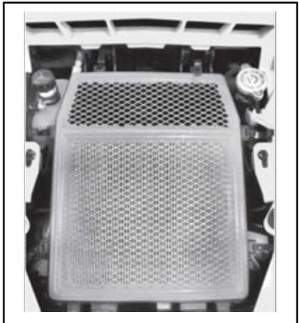
5. Compruebe que la tapa está bien colocada en el alojamiento del filtro de aire del motor antes de cerrar las sujeciones.
