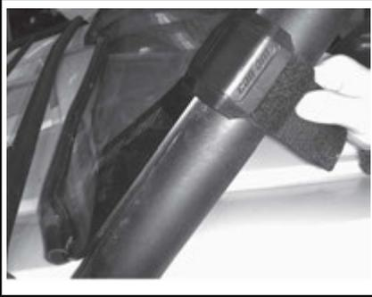
Instale los tornillos de sujeción del parabrisas y apriételos según las especificaciones.
