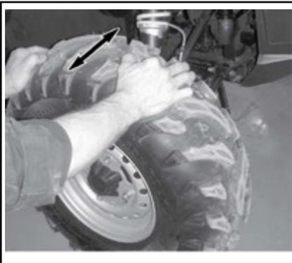
**TYPIQUE****Roues et pneus****Dépose d'une roue**
