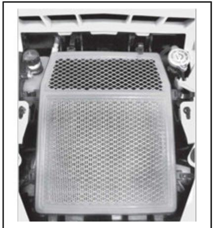
5. Vérifiez que le couvercle s'adapte bien au boîtier du filtre à air du moteur avant de fermer les fixations.
