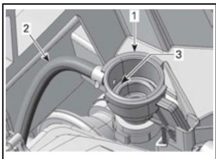
1. Adapter zum Auffüllen des Kühlsystems
