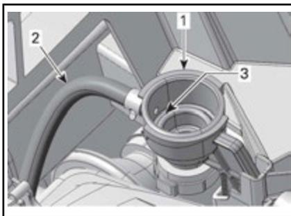
1. Adapter zum Auffüllen des Kühlsystems
