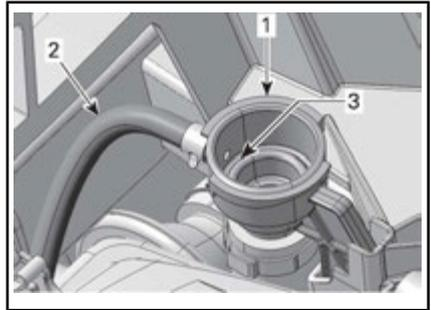
1. Adapter zum Auffüllen des Kühlsystems
