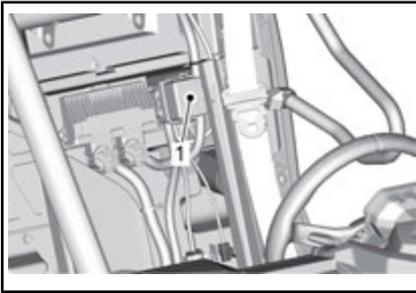
1. Hinterer Sicherungskasten
