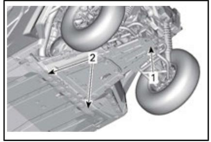
1. Hebestelle unter der Schutzplatte
