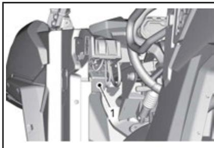
1. Vorderer Sicherungskasten
