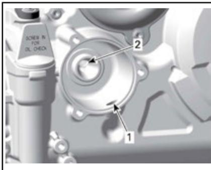
1. Einlass-Bohrung der Ölpumpe zum Ölfilter
