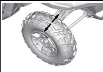
**CONFIGURAZIONE TIPICA****Pneumatici e ruote****Rimozione ruota**
