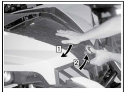
Schritt 1: Drücken Sie die Wartungsabdeckung herunter und HALTEN Sie diese fest
