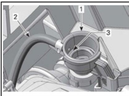
1. Adapter zum Auffüllen des Kühlsystems
