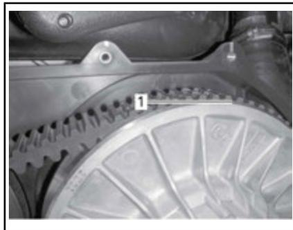
1. Parte inferior de los dientes en la superficie externa de la correa conductora a la altura del borde de la polea conducida
