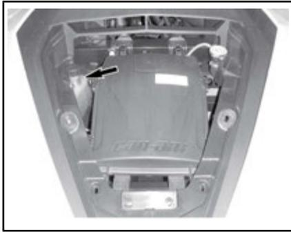
El refrigerante debería llegar hasta la marca **MIN** con el motor FRIO.
