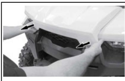
**AN DEN VORDEREN KANTEN DER WARTUNGSABDECKUNG ZIEHEN.**
