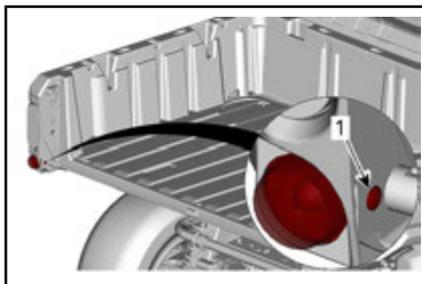
1. Vite di fissaggio della lente
