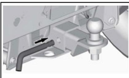
Piegare il fermo per fissare il perno.
