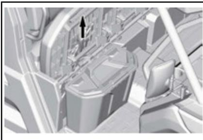
**NOTA:** Quando si reinstalla il vano portabagagli sotto il sedile, assicurarsi di allinearli correttamente ai tubi del sedile e ai rilievi del pavimento del veicolo, in modo che si adattano perfettamente sotto il sedile.
