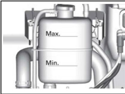
6. Aggiungere liquido refrigerante nel sistema se necessario. Usare un imbuto per impedire le perdite di liquido. **Non riempire eccessivamente.**
