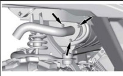
**BULLONI DI BLOCCAGGIO DEL TUBO DI SCARICO**
