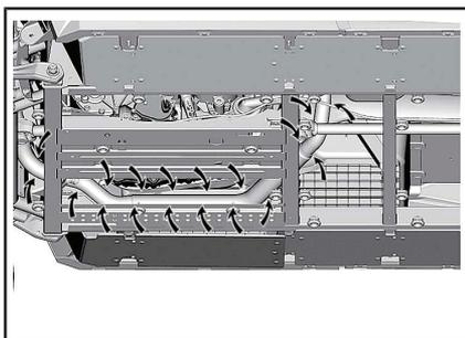
2. Avec un tuyau d'arrosage, nettoyez soigneusement la zone de sorte qu'il n'y ait plus de débris qui peuvent être en contact avec l'échappement.
