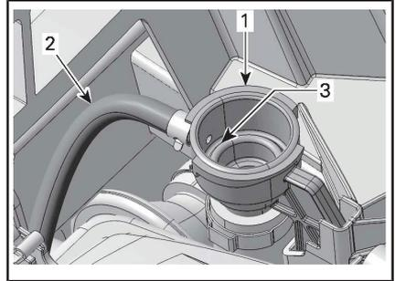
1. Adaptateur de remplissage du système de refroidissement
