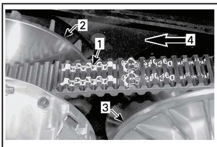
1. Flèche imprimée sur la courroie
