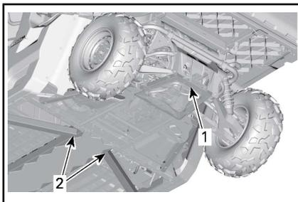
1. Ubicación de elevación debajo del enganche del remolque
