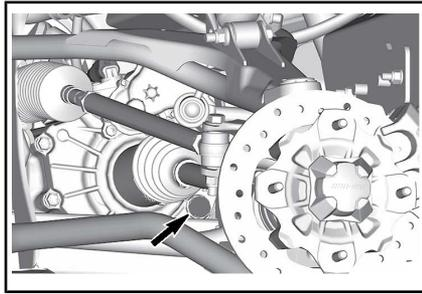
*SMART-LOK TÍPICO - LATERAL DERECHO DELANTERO DEL VEHÍCULO*
