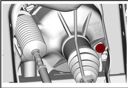
*VISCO-LOK TÍPICO - LATERAL DERECHO DELANTERO DEL VEHÍCULO*
