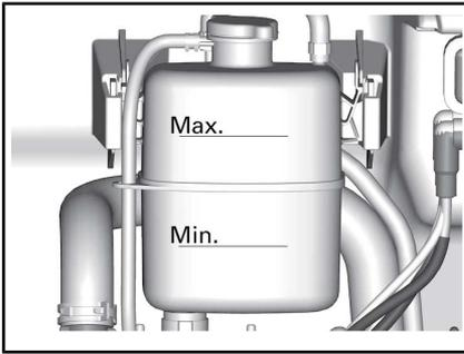
5. Añada refrigerante al sistema si es necesario. Utilice un embudo para evitar que se derrame. **No llene excesivamente el depósito.**
