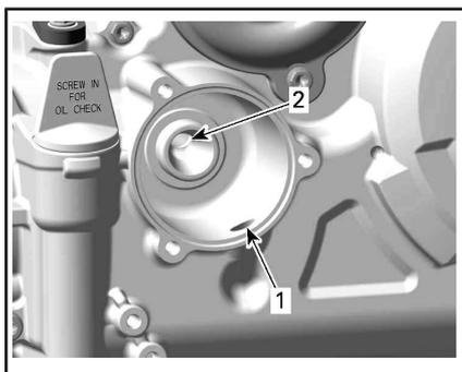
1. Orifice d'admission allant de la pompe à huile au filtre à huile
