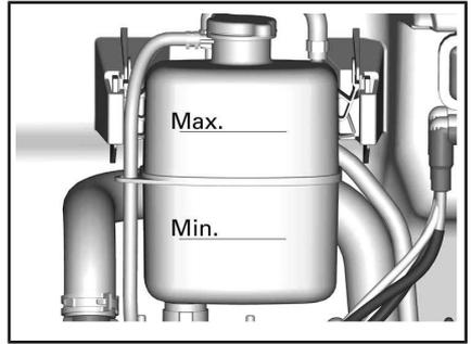
5. Ajoutez du liquide de refroidissement dans le système lorsque nécessaire. Utilisez un entonnoir pour éviter de renverser du liquide. **Évitez tout remplissage excessif.**
