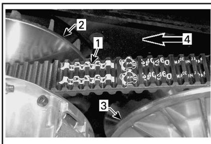
1. Flèche imprimée sur la courroie
