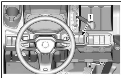
1. Interrupteur du mode du différentiel avant
