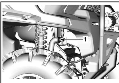
1. Boyau inférieur de radiateur à débrancher
