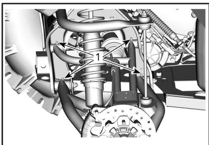
1. Raccords de graissage de bras de suspension arrière
