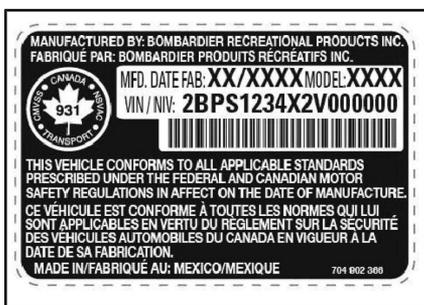
*TYPIQUE — L'ÉTIQUETTE DU NUMÉRO DE SÉRIE DU VÉHICULE SOUS LA BOÎTE À GANTS*
