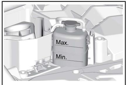
5. Aggiungere liquido refrigerante nel sistema se necessario. Usare un imbuto per impedire
