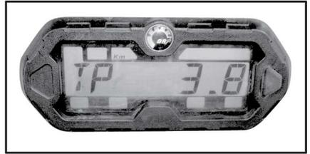
Può essere usato per stabilire la resa di un pieno di carburante, oppure per misurare la distanza di due diversi percorsi.
