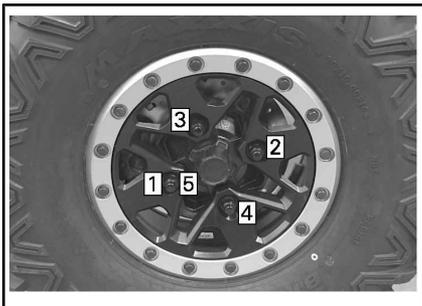
**AVISO** Use sempre as porcas de roda recomendadas para o tipo de roda. Utilizar porcas diferentes pode danificar o aro ou os parafusos das rodas.
