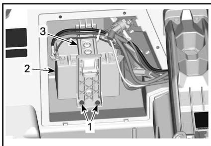
1. Parafusos de retenção do suporte da bateria
