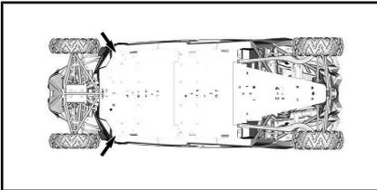
*POSIÇÕES DE APOIO DO MACACO - PARTE DIANTEIRA DO VEÍCULO*
