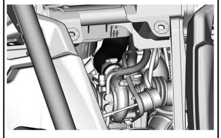
Levante o conjunto do intercooler. Desconecte o conector da ventoinha do intercooler.
