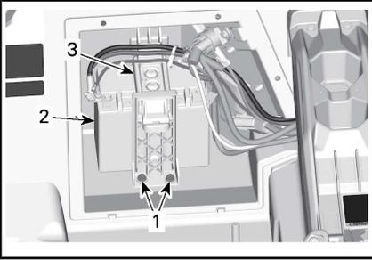
1. Tornillos de sujeción del portabaterías
