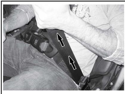
Para aflojar el cinturón, sujete el cinturón del regazo con una mano y tire de la correa roja hacia afuera.
