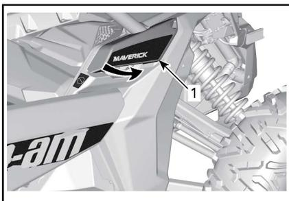
1. Cubierta del tapón del depósito de combustible
