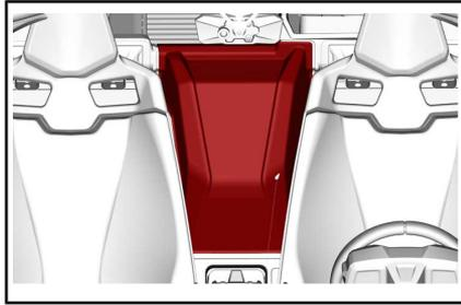
Retire los tornillos de fijación delanteros de la placa protectora.
