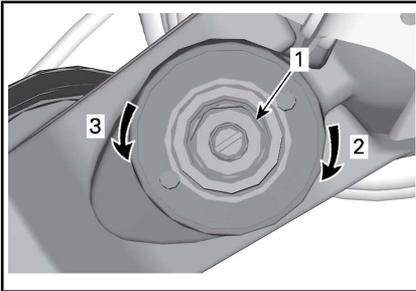
**AMORTIGUACIÓN DE COMPRESIÓN A VELOCIDAD ALTA (UTILICE UNA LLAVE DE 17 MM)**
