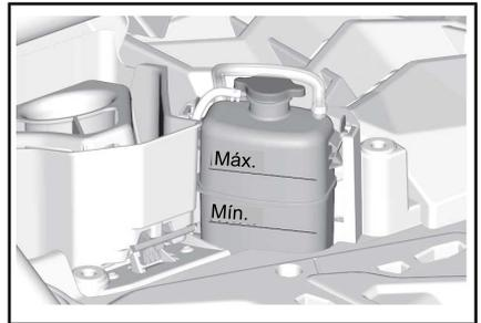
5. Añada refrigerante al sistema si es necesario. Utilice un embudo para evitar que se derrame. **No llene excesivamente el depósito.**
