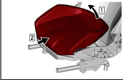
Tire hacia arriba de la parte trasera del cojín, y luego extráigalo del bastidor del asiento tirando de ella hacia atrás.
