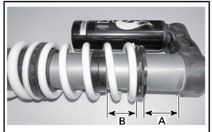
**TÍPICO - AJUSTE DE LA SUPERPOSICIÓN - AMORTIGUADOR TRASERO**
