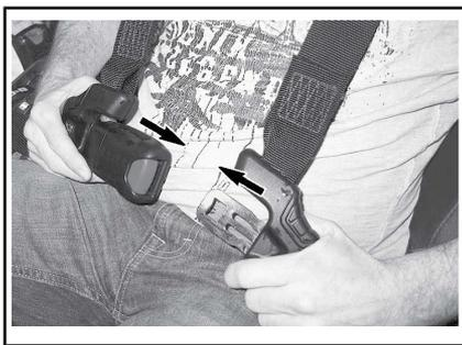
En ambos lados, ajuste el cinturón firmemente contra su cuerpo tirando del exceso de cinturón del regazo hacia el interior. La hebilla debe estar centrada en la cintura (lo más baja posible).
