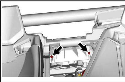
Desconecte la manguera del intercooler.
