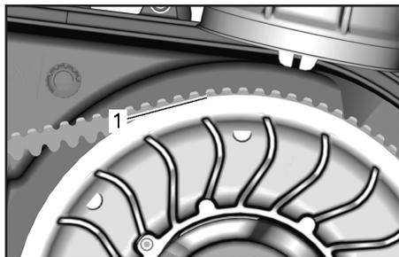
1. Нижние поверхности зубьев вровень с наружной поверхностью шкива вариатора
