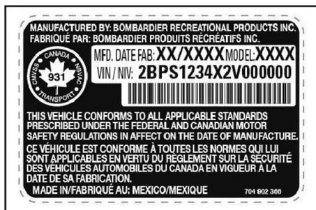
ТИПОВОЙ ВАРИАНТ — НАКЛЕЙКА С СЕРИЙНЫМ НОМЕРОМ МОТОВЕЗДЕХОДА ЗА СИДЕНЬЕМ ПассажиРА
