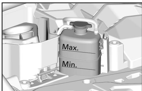
5. При необходимости добавьте в систему охлаждающую жидкость. Во избежание разлива охлаждающей жидкости пользуйтесь воронкой. **Не переливайте.**
