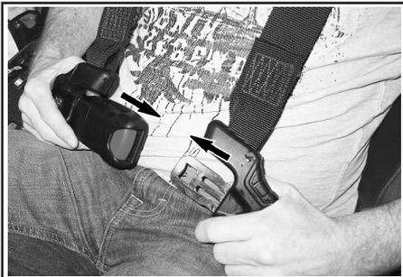
С обеих сторон отрегулируйте плотность прилегания ремня к телу, потянув свободные концы поясного ремня внутрь. Защелка должны быть отцентрирована на уровне линии талии (как можно ниже).
