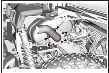
1. Tornillos de sujeción del tubo de escape
