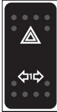
**NOTA:** Las luces de advertencia de peligro o de emergencia pueden accionarse incluso cuando está desconectado el sistema eléctrico del vehículo.
