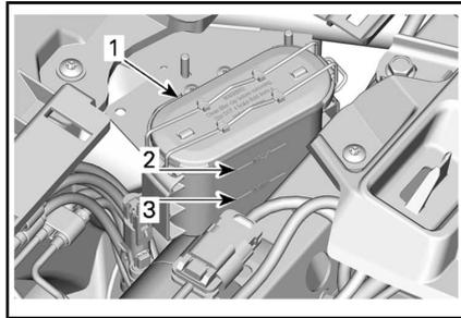
1. Depósitos de líquido de frenos
