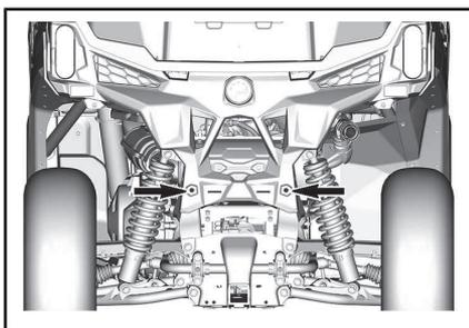
2. 在右侧，拆下空气滤清器检修盖和侧板。
