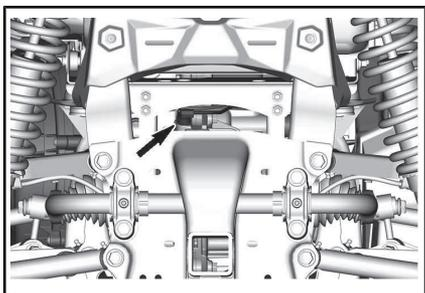
在车辆的下方，请在机油排放塞区域下方放置一个泄油盘。
