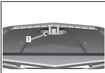
1. 检修盖下侧的定位槽
