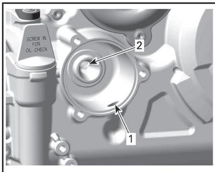
1. 从机油泵至机油滤清器的进口孔
