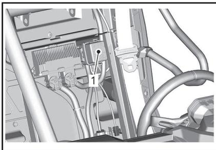
1. Hinterer Sicherungskasten
