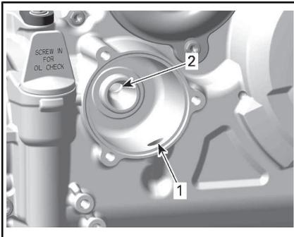
1. Einlass-Bohrung der Ölpumpe zum Ölfilter
