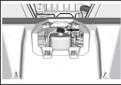
2. Geben Sie nach Bedarf Kühlmittel in das System. Mit einem Trichter vermeiden Sie das Verschütten von Flüssigkeit. **Nicht überfüllen.**
