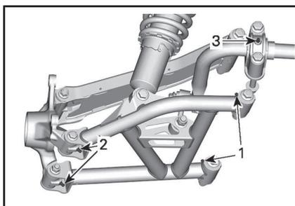
1. Schmieren Sie die Schmiernippel an den Querlenkern.
