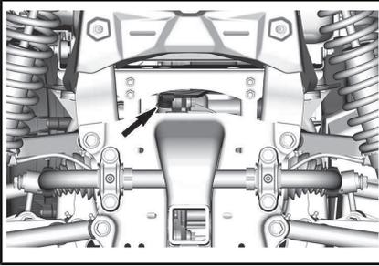
Stellen Sie unter dem Fahrzeug eine Auffangschale unter den Bereich der Ölablassschraube.
