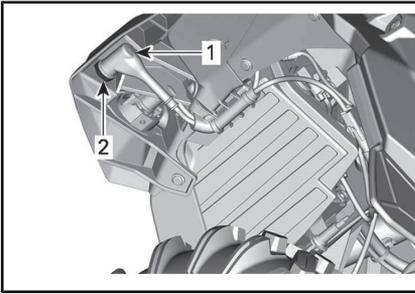
1. Positionieren Sie den elektrischen Steckverbinder der Leuchte.
