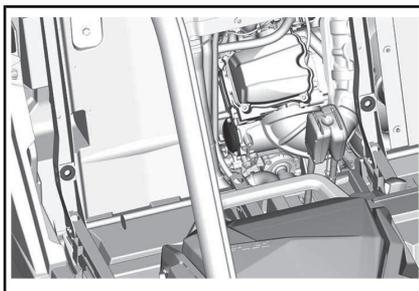
Entfernen Sie die Ölfilterabdeckung.
