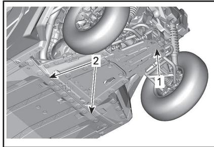
1. Hebestelle unter der Schutzplatte
