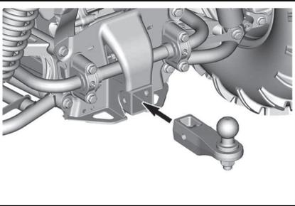
Stecken Sie den Stift durch die Zugstange und die Empfängerkupplung.
