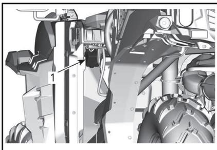
1. Vorderer Sicherungskasten
