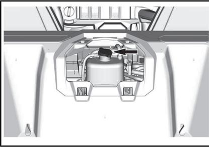
2. Añada refrigerante al sistema si es necesario. Utilice un embudo para evitar que se derrame. **No llene excesivamente el depósito.**
