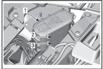
1. Depósitos de líquido de frenos
