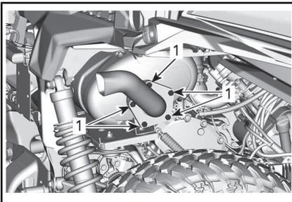
1. Tornillos de sujeción del tubo de escape
