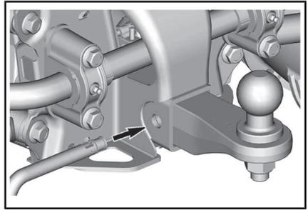
Fixez la goupille en place en repliant l'embout de verrouillage.
