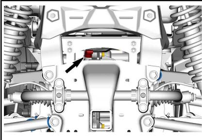
Sotto il veicolo, posizionare una bacinella per la raccolta dell'olio sotto il tappo di scarico.
