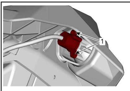
1. Vite di fissaggio della lente
