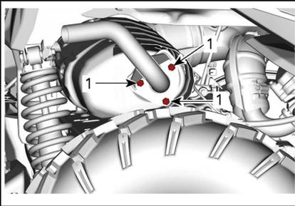
1. Viti di bloccaggio del tubo di scarico
