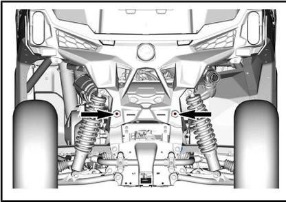
2. Sul lato DX, rimuovere il coperchio di accesso al filtro dell'aria e il pannello laterale.
