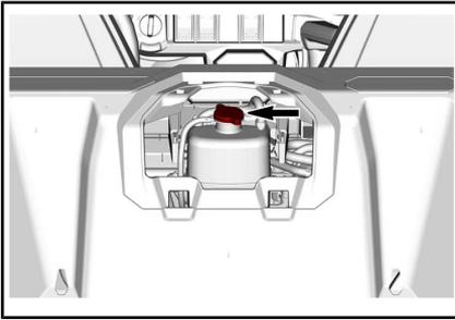
2. Aggiungere liquido refrigerante nel sistema se necessario. Usare un imbuto per impedire le perdite di liquido. **Non riempire eccessivamente.**
