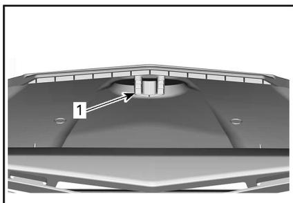
1. Fessura di posizionamento sul lato inferiore del coperchio di manutenzione
