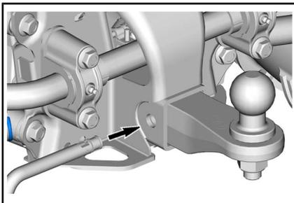
Fissare il perno piegando il blocco.
