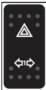
**NOTA:** È possibile attivare le luci di segnalazione pericolo anche quando il sistema elettrico del veicolo è disattivato.
