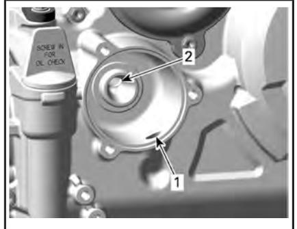
1. Einlass-Bohrung der Ölpumpe zum Ölfiler
