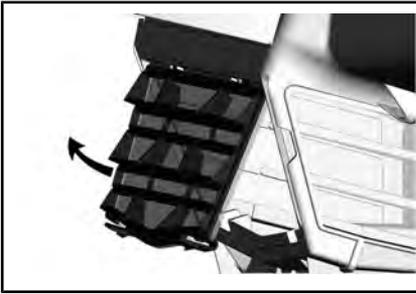
Reinigen Sie die Luftfilter, indem Sie sie in einer Mischung aus lauwarmem Wasser und milder Seife waschen. Entfernen Sie überschüssiges Wasser und trocknen Sie die Filter vor dem Einbau an der Luft.
