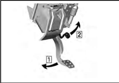
Schritt 1: *Betätigen Sie das Bremspedal und halten Sie es gedrückt.*
