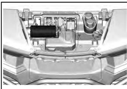
Zum Ausbauen Filter anheben und verschieben.
