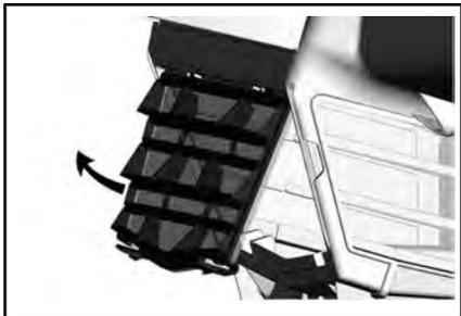
Nettoyez les filtres à air en les lavant à l'eau tiède avec un savon doux. Enlevez l'excès d'eau et séchez à l'air avant l'installation.
