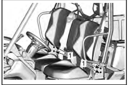
1. Attaches inférieurs de la cage
