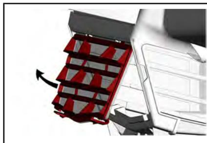
Nettoyez le filtre à air en le lavant à l'eau tiède avec un savon doux. Enlevez l'excès d'eau et séchez à l'air avant l'installation.
