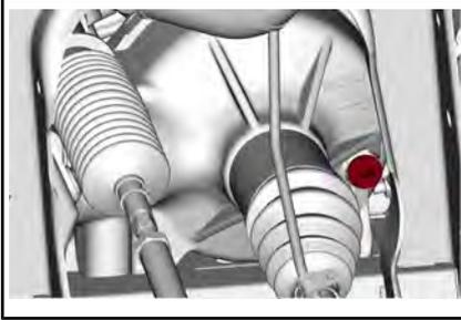
*TYPIQUE VISCO-LOC -- CÔTÉ DROIT AVANT DU VÉHICULE*
