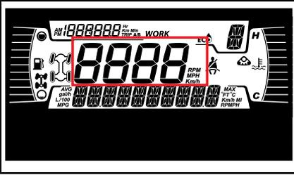
Indique la vitesse du véhicule en km/h ou en mi/h.
