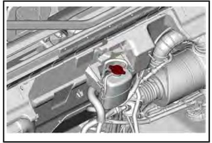
3. Dévissez le bouchon de vidange de liquide de refroidissement et vidangez le liquide dans un contenant approprié.
