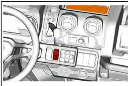
L'interrupteur du différentiel permet le verrouillage du différentiel arrière.
