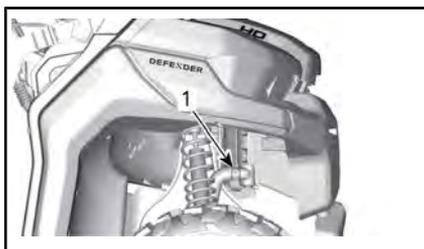
1. Boyau inférieur de radiateur à débrancher
