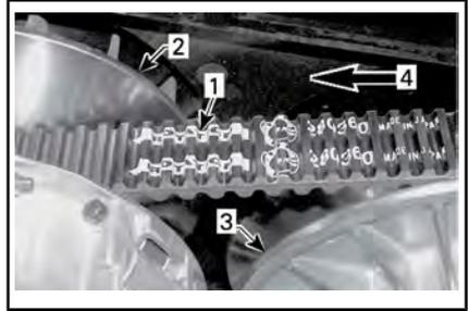
1. Flèche imprimée sur la courroie
