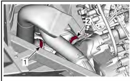
1. Fixation du conduit de sortie
