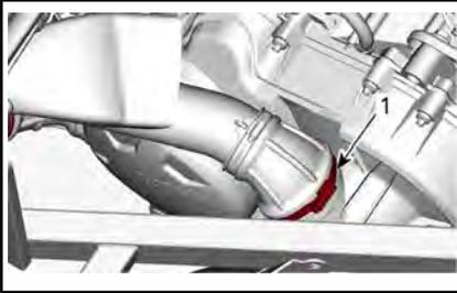
1. Fixation du conduit d'entrée arrière
