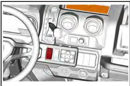
Ce sélecteur sélectionne le mode de traction à 2 ou 4 roues motrices lorsque le véhicule est arrêté et que le moteur est en marche.
