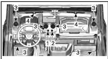
1. Bouton de commande de vitesse de ventilateur de chauffage
