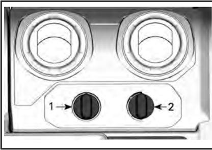
1. Bouton de commande de vitesse de ventilateur de chauffage
