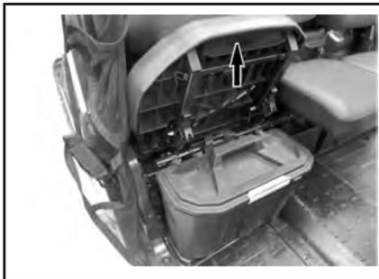
**REMARQUE :** Lorsque vous réinstallez la boîte de rangement sous le siège, assurez-vous de l'aligner correctement avec les tubes de siège et la section en relief pour qu'elle s'installe correctement sous le siège.
