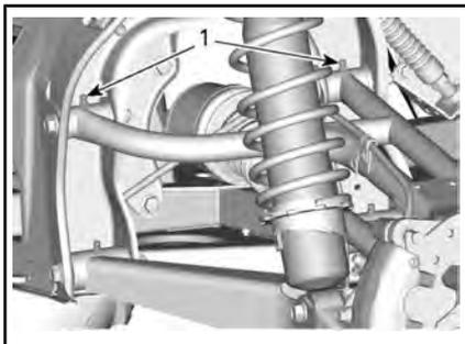
1. Raccords de graissage de bras triangulaire supérieur
