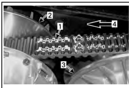
1. Flèche imprimée sur la courroie
