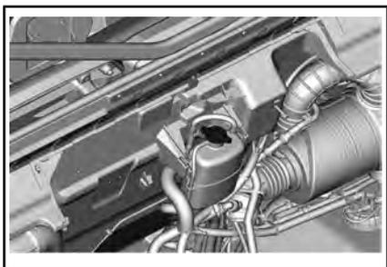
4. Dévissez le bouchon de vidange de liquide de refroidissement et vidangez le liquide dans un contenant approprié.
