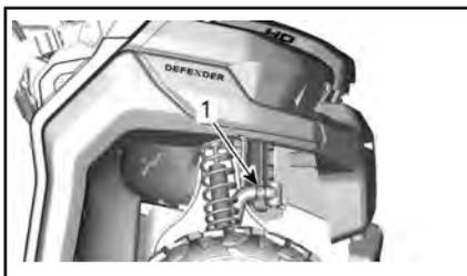
1. Boyau inférieur de radiateur à débrancher
