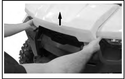
DE RAND VAN HET VOORSTE ONDERHOUDSDEKSEL OPTILLEN.
