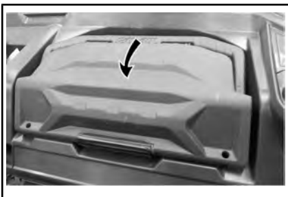
DE AFNEEMBARE GEREEDSCHAPSKIST ONTGRENDELEN
