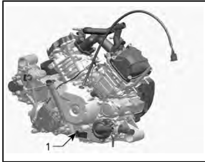
TYPISCH — LABEL MET SERIENUMMER MOTOR
