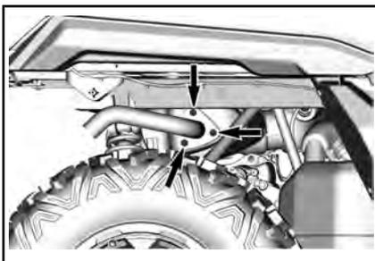
*TYPIQUE - VIS DE FIXATION DU TUYAU ARRIÈRE*
