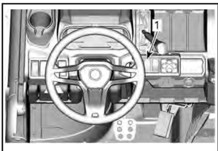
1. Interrupteur du différentiel avant / 2 / 4 roues motrices
