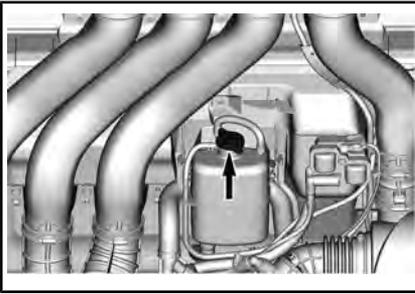
3. Dévissez le bouchon de vidange de liquide de refroidissement et vidangez le liquide dans un contenant approprié.
