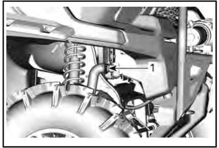
1. *Boyau inférieur de radiateur à débrancher*
