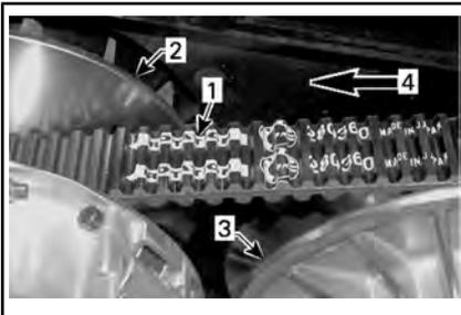
1. Flèche imprimée sur la courroie
