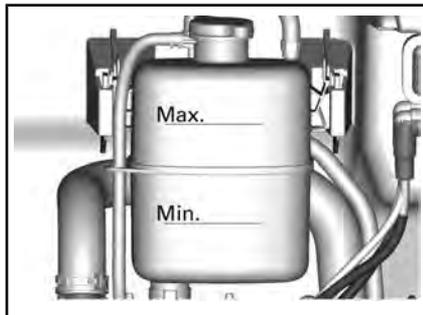
5. Añada refrigerante al sistema si es necesario. Utilice un embudo para evitar que se derrame. **No llene excesivamente el depósito.**
