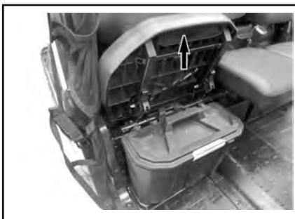
**NOTA:** Cuando vuelva a colocar la caja de almacenamiento debajo del asiento, asegúrese de alinearla correctamente con los tubos del asiento y el relieve del suelo para que encaje correctamente debajo del asiento.
