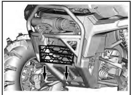
Para instalarla, inserte las pestañas superiores primero y empuje la parte inferior.
