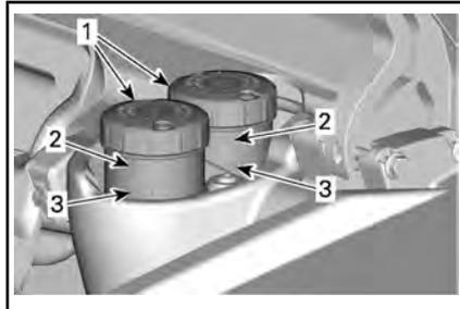
1. Depósitos de líquido de frenos
