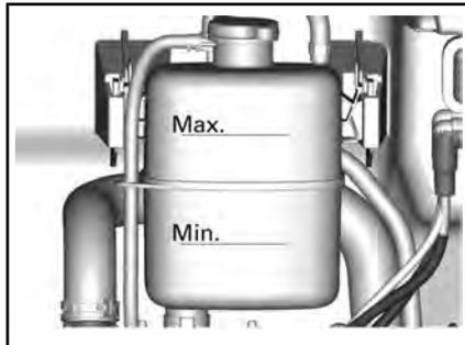
5. Adicione líquido de arrefecimento no sistema se necessário. Use um funil para não derramar. **Não complete além da capacidade.**
