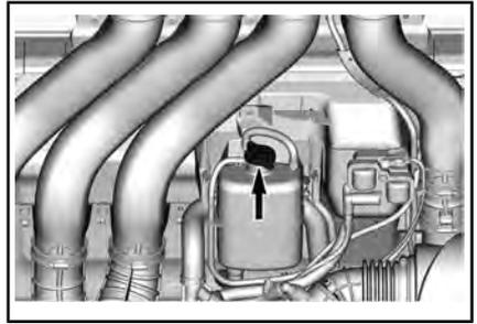
3. Desenrosque o bujão de drenagem do líquido de arrefecimento e drene o líquido de arrefecimento em um recipiente apropriado.
