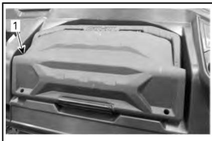
Para abrir a caixa de ferramentas, destrave o painel e levante a tampa.
