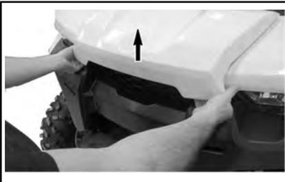
*TÍPICO - LEVANTANDO A EXTREMIDADE DA TAMPA DE SERVIÇO DIANTEIRA.*
