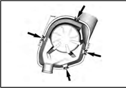
Entfernen Sie die Filterpatrone.
