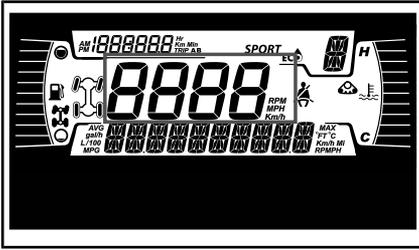
Anzeige der Fahrzeuggeschwindigkeit in km/h oder mph.
