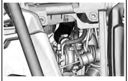
Den Ladeluftkühler und die Schlauchhalterung des Kurbelgehäuses durch Lösen der Schraube öffnen.
