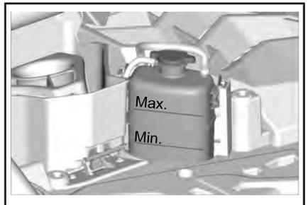
5. Geben Sie nach Bedarf Kühlmittel in das System. Mit einem Trichter vermeiden Sie das Verschütten von Flüssig-
