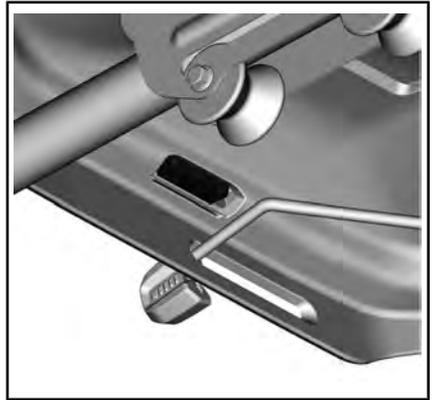
Ziehen Sie das hintere Ende des Kissens hoch und dann aus dem Rahmen, indem Sie es nach hinten herausziehen.
