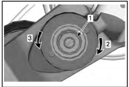
**EINFEDERUNGSDÄMPFUNG (HOHE GESCHWINDIGKEIT), (EINEN 17-MM-SCHRAUBENSCHLÜSSEL VERWENDEN)**
