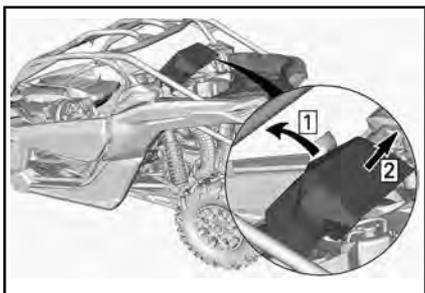
Entfernen Sie das CVT-Luftfilter vom Fahrzeug.
