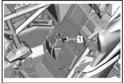
1. Hinterer Sicherungskasten
