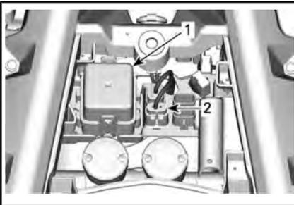
1. Vorderer Sicherungskasten
