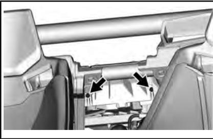
Entfernen Sie die Schutzplatte.
