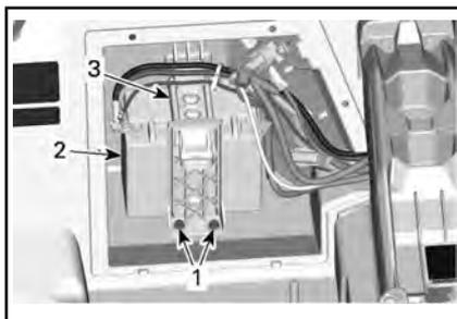
1. Halteschrauben des Batteriebügels
