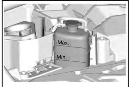
5. Adicione líquido de arrefecimento no sistema se necessário. Use um funil para não derramar. **Não complete além da capacidade.**
