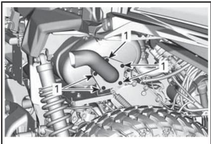
1. Parafusos de retenção do cano de escapamento
