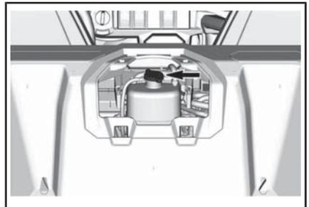
2. Adicione líquido de arrefecimento no sistema se necessário. Use um funil para não derramar. **Não complete além da capacidade.**
