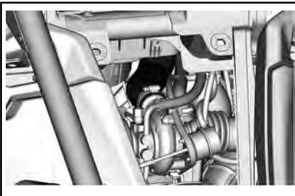
Abra el interrefrigerador y el soporte de la manguera del cárter quitando el tornillo.
