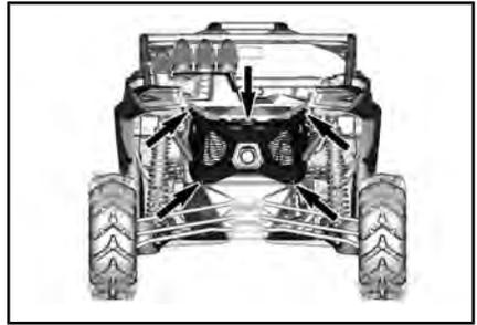
Retire y deseche los tornillos y tuercas de fijación.
