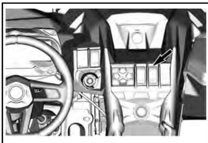
El interruptor de modo del diferencial delantero se utiliza para elegir entre el modo TRAIL (pista) o el modo MUD (barro).
