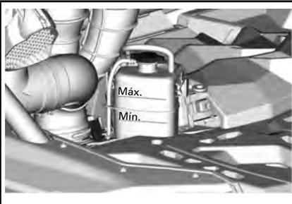
5. Añada refrigerante al sistema si es necesario. Utilice un embudo para evitar que se derrame. **No llene excesivamente.**
