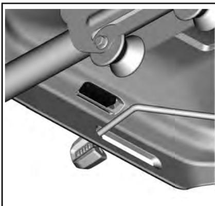
Tire hacia arriba de la parte trasera del cojín, y luego extráigalo del bastidor del asiento tirando de ella hacia atrás.
