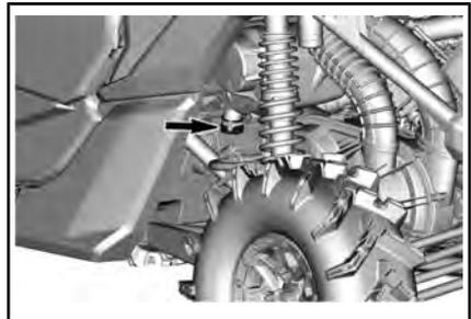
Las rejillas del esnórquel se pueden desmontar para la limpieza.
