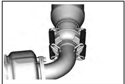
Tire del supresor de chispas y retire los depósitos de carbono con un cepillo.
