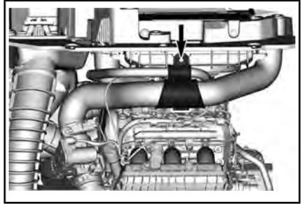
Levante el conjunto del intercooler. Desconecte el conector del ventilador del intercooler.
