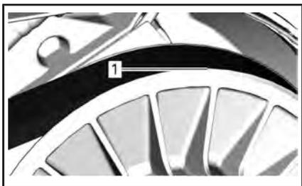
1. Superficie esterna della cinghia di trasmissione
