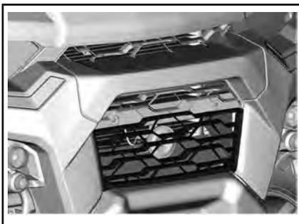
Controllare periodicamente che la superficie vicino al radiatore sia pulita.
