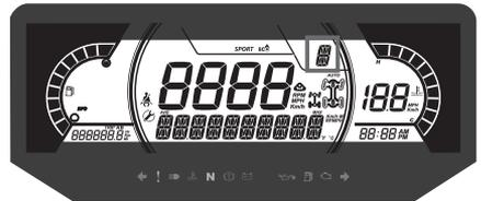
Diese Anzeige zeigt die Getriebestellung an:
