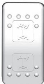
Le commutateur sélectionne le mode 2 roues motrices ou le mode 4 roues motrices lorsque le véhicule est arrêté.
