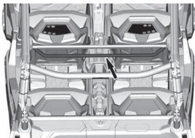
S'agripper à la poignée permet au passager de contrecarrer les mouvements du véhicule et de garder les mains et le corps à l'intérieur de l'habitacle lors d'un capotage.
