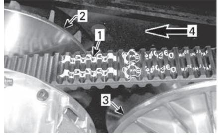
1. Flèche imprimée sur la courroie
