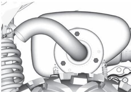
2. Déposez le tuyau d'échappement, le joint (mettre au rebut) et le pare-étincelles
