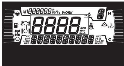
Indique la vitesse du véhicule en km/h ou en mi/h.
